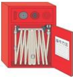
屋内消火栓設備
